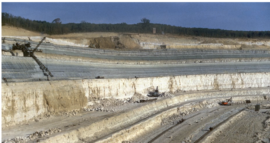
► La carrière de Cormeilles, au plus fort de son extension au début des années 1960, est exploitée par gradins selon les différentes couches géologiques.
