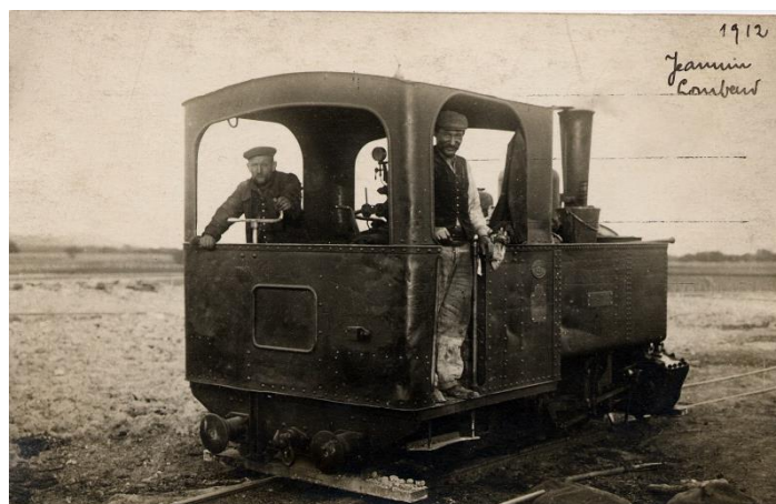
► Locomotive de carrière Decauville type 6 dans la carrière de Cormeilles en 1912. Collection particulière.
